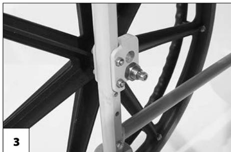
☞ Bei Bedarf lässt sich der Aufnahmeblock, durch Umschrauben nach hinten versetzen. Hierdurch wird eine Radstandverlängerung erreicht.
