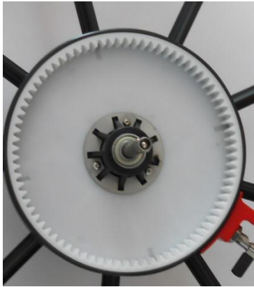
Bild 1: Zahnscheibe mit Führungsblech
