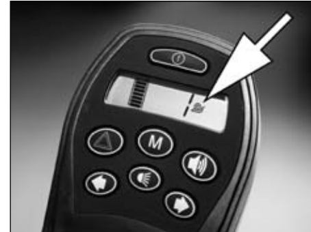
Abb. 24 Schneckensymbol zur Erkennung des Kriechganges
