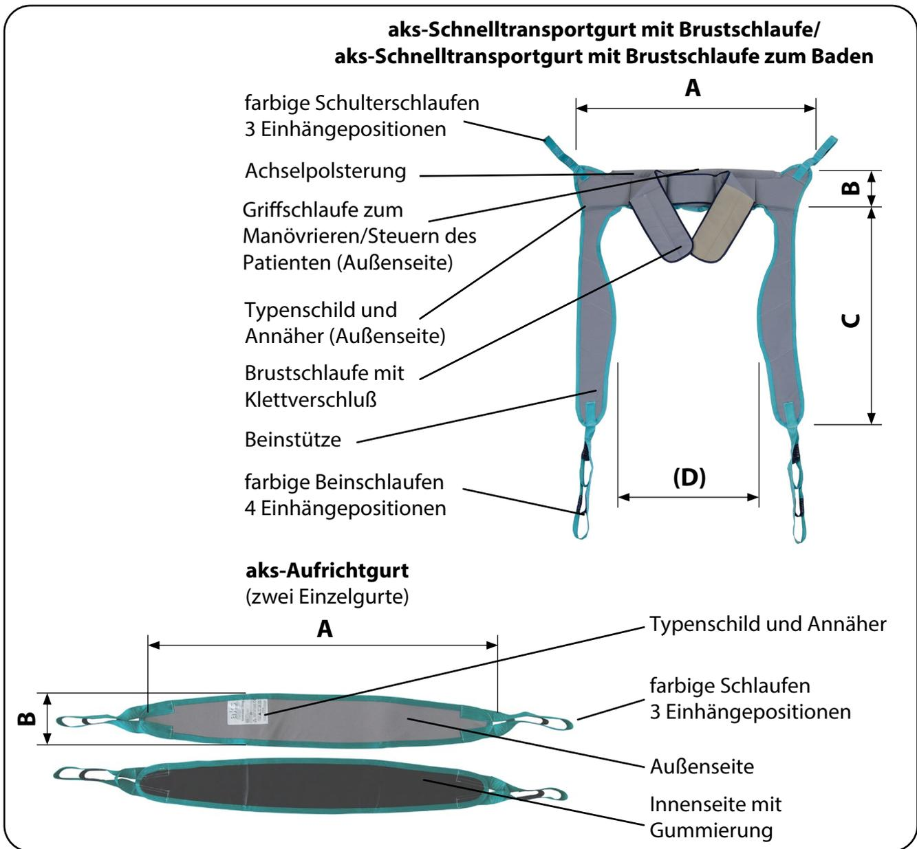
Abb. 5.01 – Innenseite des aks-Schnelltransportgurtes mit Brustschlaufe/
