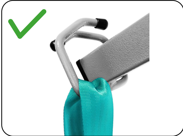
Abb. 6.4.01 - Gurtschleufe richtig eingehangen
