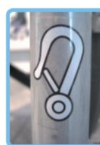
Si le fauteuil doit être soulevé, par exemple à l'aide d'une grue à potence, afin de franchir un obstacle, les seuls points d'attache à utiliser pour le levage sont les 4 points signalés par l'autocollant représentant un crochet (voir la fig. de gauche) sur le châssis du fauteuil.
