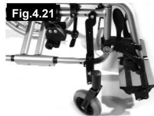
Um die Sitzhöhe vorne einzustellen, lösen Sie bitte die Schrauben A (2 pro Seite) und stellen Sie die gewünschte Sitzhöhe ein. Stellen Sie sicher, dass beide Seiten dieselbe Höhe aufweist und ziehen Sie die Schrauben wieder fest an. Beachten Sie bitte das Drehmoment Nm (siehe Seite Anzugsmomente).
