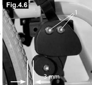
Fig.4.6 4.6 Kniehebelbremse
