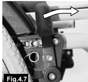
Fig.4.7 4.7 Standardbremse
