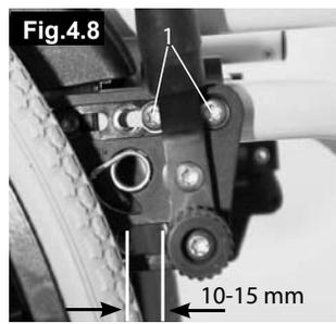
Fig.4.8 4.8 Standardbremse
