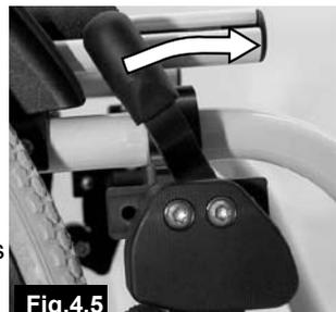
Fig.4.5 4.5 Kniehebelbremse
