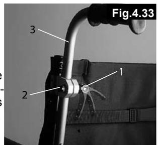
bewegen. Die Mutter (2) am Spannhebel gibt die Klemmung am Schiebegriffhalter vor. Eine lose Mutter führt nach Umlegen des Spannhebels zu einem lockeren Schiebegriff. Vor Benutzung durch zur Seite drehen des Schiebegriffes feststellen, ob die Klemmung ausreichend ist. Nach Einstellen der Höhe den Spannhebel (1) stets fest klemmen. Bei nicht festgezogenem Spannhebel kann es beim Treppensteigen zu Verletzungen kommen.
