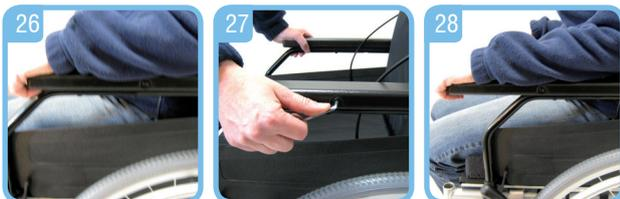
Zum Wegschwenken der Armlehne nach hinten betätigen Sie den Entriegelungshebel vorn an der Armlehne und halten diesen, bei gleichzeitigem hochziehen der Armlehne, gedrückt bis die Armlehne frei ist. Nun kann sie nach hinten weggeschwenkt werden. (Bild 29+30)
