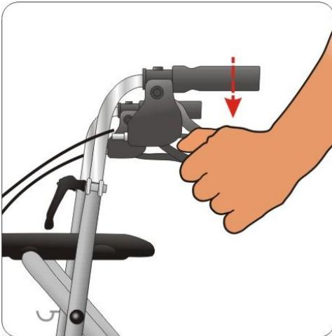
Zum Feststellen/Parken des Rollators beide Bremsgriffe nach unten drücken bis sie hörbar einrasten (siehe Bild)! Zum Entriegeln der Bremse beide Bremsgriffe wieder nach oben ziehen bis sie entriegelt sind (Bremsgriffe sind in mittlerer Position).
