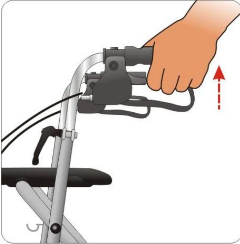
Zum Bremsen während des Gehens mit dem Rollator beide Bremsgriffe mit den Händen nach oben ziehen (siehe Bild). Immer langsam und gleichmäßig mit beiden Händen bremsen.
