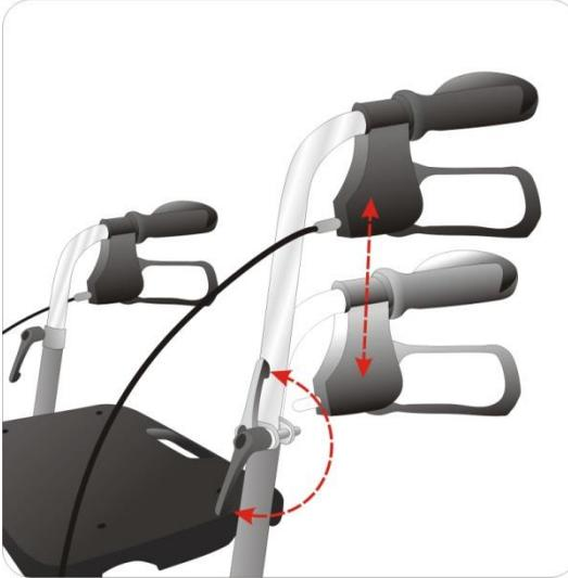
Schiebegriffe mindestens bis zur „Maximum“-Markierung in das Rahmen-Rohr einstecken. Durch Drehen des Feststellhebels im Uhrzeigersinn in der gewünschten Höhe feststellen. Beide Griffe in gleicher Höhe einstellen.
