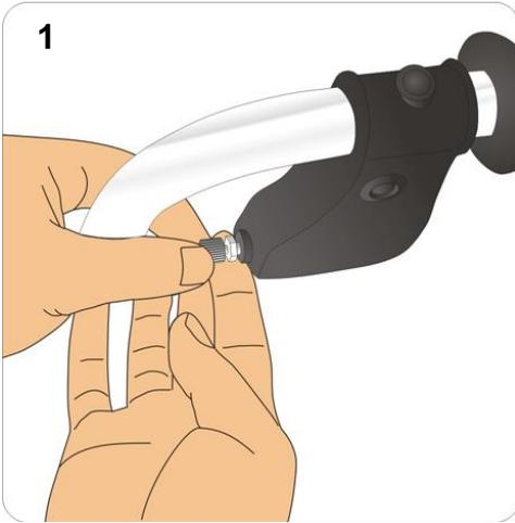
Bei schlechter oder zu harter Bremswirkung kann die Bremse entweder am Bremsgehäuse oben (Bild 1) oder mit entsprechendem Werkzeug (nicht in Lieferung enthalten) an der Einstellschraube am Bowdenzug unten (Bild 2) auf die gewünschte Bremswirkung eingestellt werden.
