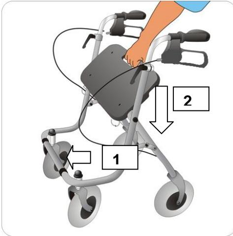
Rollator auf die Räder stellen. Vorderrahmen nach vorne drücken indem ein Handgriff schräg nach unten hinten gezogen wird bis Rollator auf vier Rädern steht.
