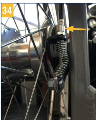
Pour obtenir un freinage optimal, ajustez la force de freinage au moyen de la vis de réglage.
