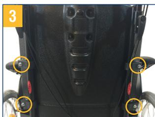
Als u de hoogte van de rugleuning wilt instellen, draait u de 4 inbuschroeven van de bevestigingsklemmen los. Schuif de rugleuning naar de gewenste positie en draai de schroeven weer vast.
