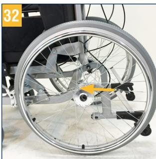
Avant de démonter les roues motrices, faites le nécessaire pour que le fauteuil roulant ne bascule pas.
