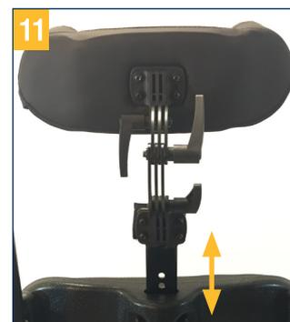
Lassen Sie den Arretierknopf los und ziehen Sie die Kopfstütze nach oben bis sie in der ersten Position einrastet. Sie können nun durch erneutes Ziehen des Arretierbolzens nach außen und gleichzeitigem Ziehen nach oben die Höhe der Kopfstütze verändern, achten Sie darauf dass der Arretierknopf in der gewählten Position einrastet. (Abb. 11).
