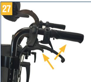
Pour garer le fauteuil, appuyez sur le levier de frein pour serrer les freins des deux côtés. Poussez ensuite le levier de serrage sur le frein vers le bas de manière qu'il bloque le levier de frein.
