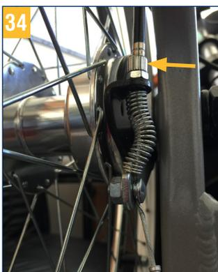
Um eine optimale Bremswirkung zu erreichen, wird die Bremskraft an der Einstellschraube justiert.
