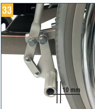
De afstand tussen de rembout en de buitenkant van de band moet bij een maximaal geopend remmechanisme op de nauwste plaats 10 mm bedragen.
