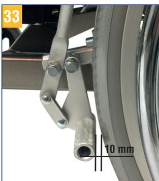
La distance entre les boulons de frein et le flanc du pneu doit être de 10 mm au point le plus étroit, le mécanisme de frein étant ouvert au maximum.
