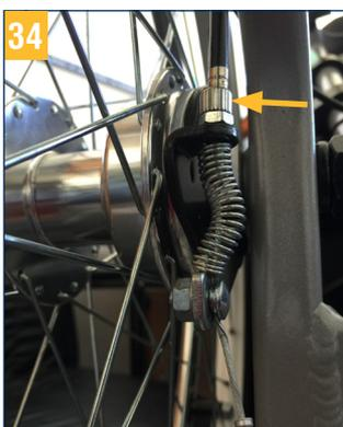
Voor een optimale werking van de rem wordt de remkracht afgesteld bij de instelschroef.
