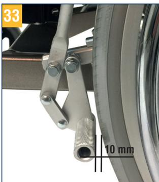
Der Abstand zwischen Bremsbolzen und Reifendecke muss bei max. geöffnetem Bremsmechanismus an der engsten Stelle 10 mm betragen.
