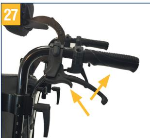
Zum Parken werden die Bremsen auf beiden Seiten festgestellt, indem der Bremshebel gedrückt wird. Schieben Sie anschließend den Feststellhebel an der Bremse nach unten, so dass dieser den Bremshebel arretiert.
